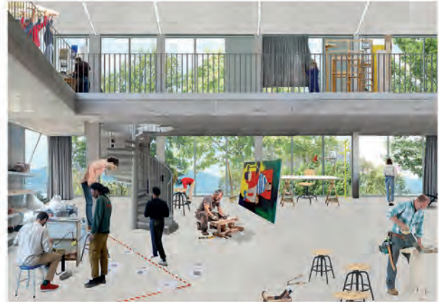
9. Un atelier productif situé au niveau R+1 ou R+2, avec hauteur libre de 5m et possibilité de mezzanine
